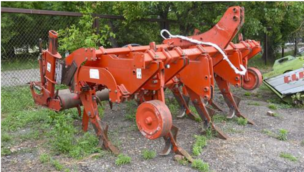
Глубокорыхлитель Gaspardo Artiglio. Ширина захвата 3 метра. Глубина рыхления до 65
